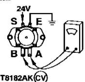
T8182AK-UN: Battery Relay Check
