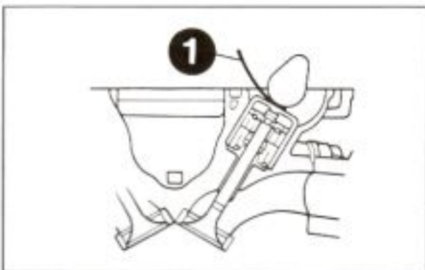
Bild 20 Ventilspiel messen 1 Fühlerlehre
