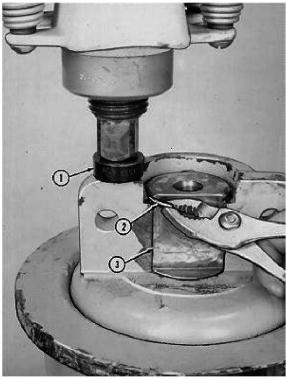
T80426-UN: Installing Outer Collar on Press
