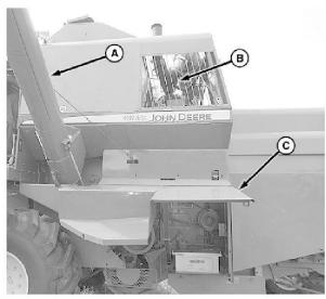
YC2284-UN: Extend Unloading Auger
