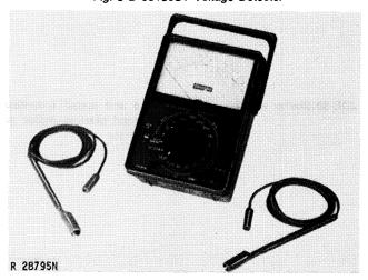
Fig. 4-D-19001TT Volt-Ohm-Amp Meter
