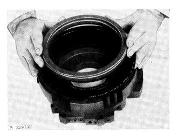
Fig. 17-Installing Brake Piston
