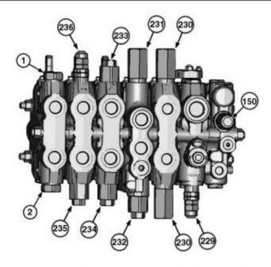
Предохранительные клапаны контура обратной лопаты (показан регулирующий клапан модели с шестью функциями)
